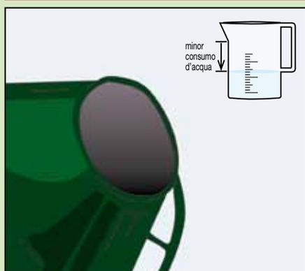
Molto spesso per aumentare la lavorabilità del calcestruzzo si aggiunge una quantità eccessiva d'acqua che ne diminuisce le caratteristiche di impermeabilità e resistenza. Per non incorrere in questi errori è indispensabile l'uso di idonei additivi che abbassano il rapporto acqua/cemento e migliorano la lavorabilità e la fluidità del calcestruzzo.
