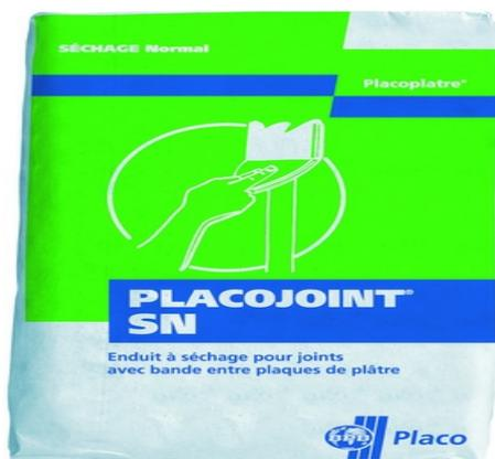
Enduit poudre à séchage permettant le traitement manuel ou mécanique des joints avec bande papier. Le redoublement des joints se fait après durcissement complet de l'enduit et dépend essentiellement des conditions climatiques (12 à 48 heures). Utili
