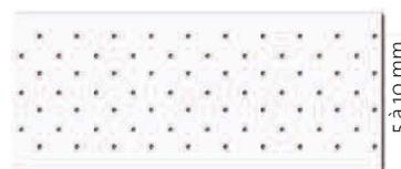
**Pleine perforation** : la zone perforée est totale y compris dans les plis du panneau apparent.
