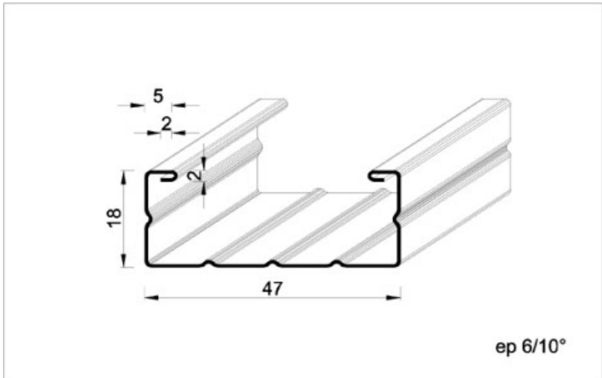
Fourrure métallique destinée à la réalisation de l'ossature des ouvrages horizontaux ou inclinés de plafonds, d'habillages et de contre cloisons avec appui intermédiaire clipsé, norme NF, conforme au DTU 20.41, existe aussi en longueur 3.00 m
