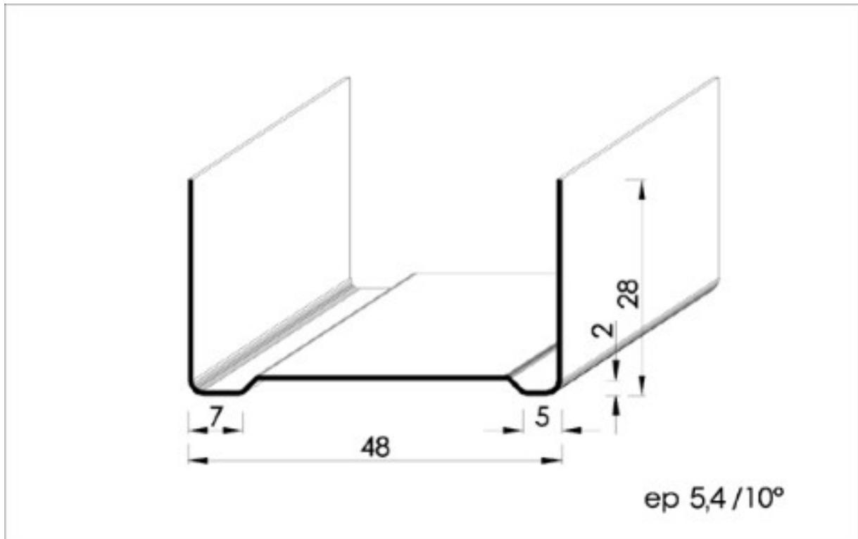
Rail métallique de 48 mm de largeur, à associer aux montants de même largeur, destiné à la réalisation de l'ossature horizontale de cloison, de contre cloison d'habillage et de plafond horizontal ou rampants, norme NF, conforme au DTU25.41
