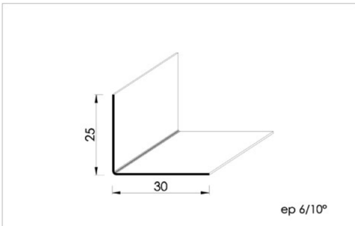
Elément périmétrique déterminant pour les plans des plafonds continus. La face de contact avec la plaque est moletée. Ils forment la structure du périmètre des plafonds continus.
