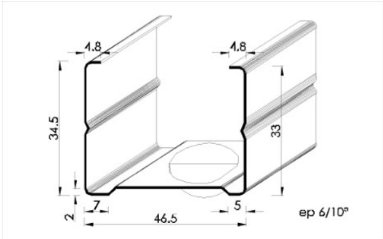
Montant métallique de 48 mm de largeur et de 35 mm d'aile destiné à servir d'appui aux plaques, à associer au rail de même largeur, pour la réalisation d'ossature verticale de cloison, de contre cloison d'habillage et de plafond horizontal ou rampants, norme NF, conforme au DTU 25.41, existe aussi en longueur 2.5 et 3 m
